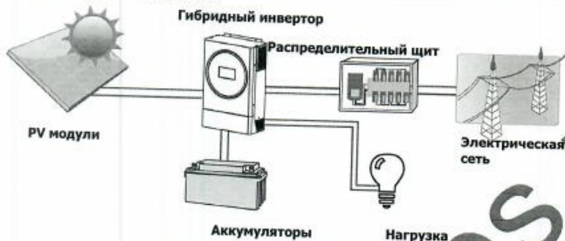
Рисунок 1: Гибридная система энергоснабжения
